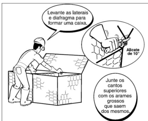
Figura 2: Posicionamento dos painéis laterais e diafragmas
